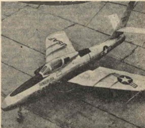
Fig. 2 - Il Republic's Thunderflash uno dei primi velivoli che utilizza il titanio per poter far fronte alla barriera termica.
