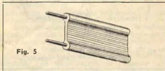
Le estremità esterne della piattina andranno collegate in corto circuito e, allo scopo di impedire che la piattina abbia ad attorcigliarsi sotto l'effetto del vento, verranno mantenute tese da due basette in materiale isolante che assolveranno inoltre funzione di isolatori. Al centro esatto del dipolo ripiegato taglieremo un solo filo della piattina (fig. 4), ottenendo in tal modo due capi, che collegheremo alla linea di discesa, essa pure in piattina.
