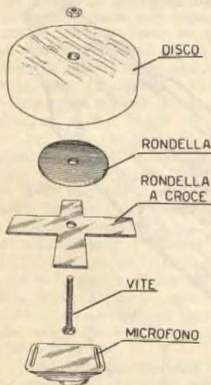
Fig. 6. — Ordine di montaggio dei componenti il porta-microfono.
