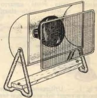
**Fig. 6. — Utilizzando la lampada a raggi infrarossi per scopi terapeutici, dovremo prevederla di uno schermo metallico anteriore.**
