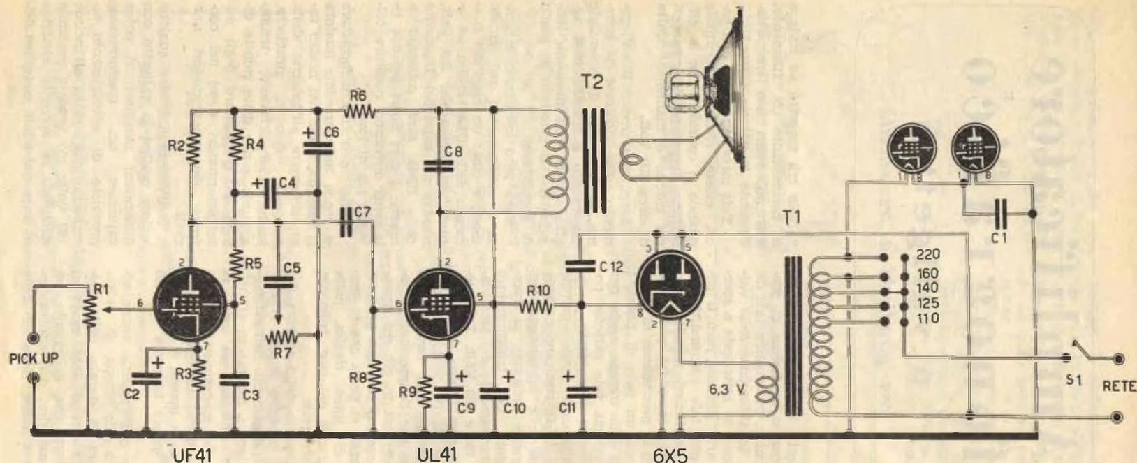
Fig. 1 - Schema elettrico dell'amplificatore
