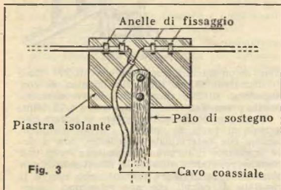
dal calcolo, andrà divisa in due tronconi eguali al fine di consentire l'applicazione dell'isolatore come indicato a fig. 1. Tale tipo d'antenna presenta sempre l'impedenza caratteristica di 75 Ohm, per cui dovremo necessariamente utilizzare, per la discesa, cavo coassiale la cui impedenza sia di 75 Ohm.
