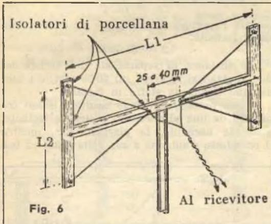
mato superiormente) è, come già abbiamo avuto modo di notare, identica a quella del primo tubo e perciò ricavabile dall'applicazione della formula  $135 : f$ ; la lunghezza dei due semibracci sporgenti dal punto di applicazione è in relazione al diametro del tubo utilizzato per la realizzazione.
