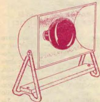
Fig. 2. — Come può essere concepita una stufetta elettrica completa di riflettore metallico.
