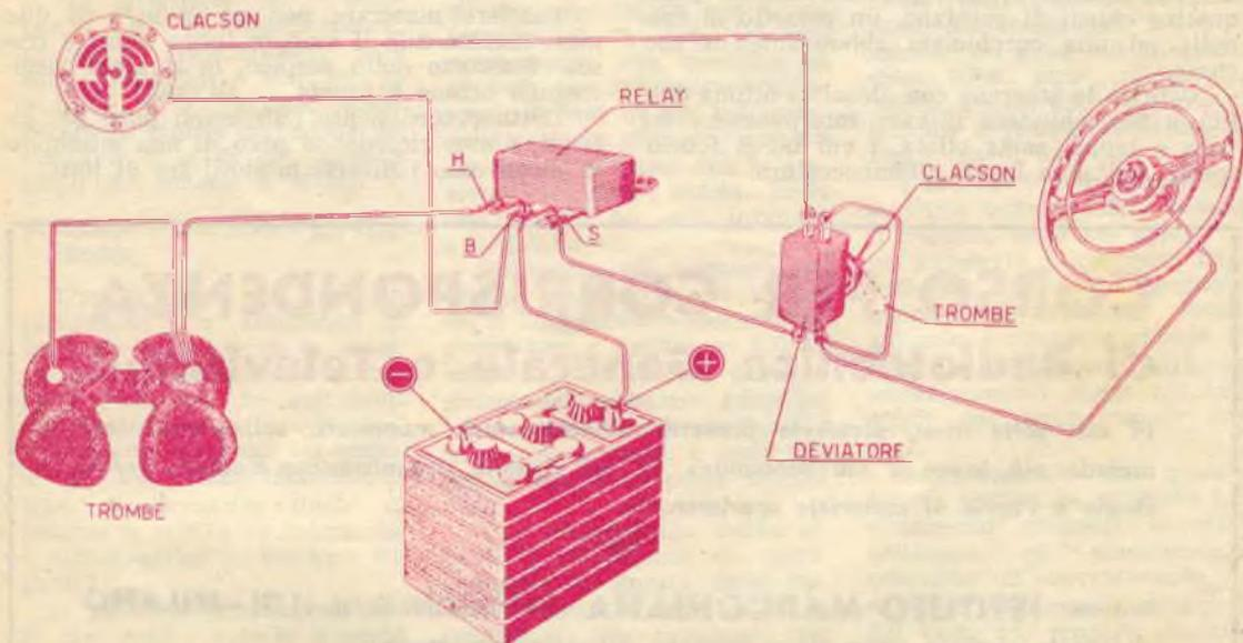
Fig. 1. — Schema elettrico per l'installazione delle trombe acustiche in una vettura.
