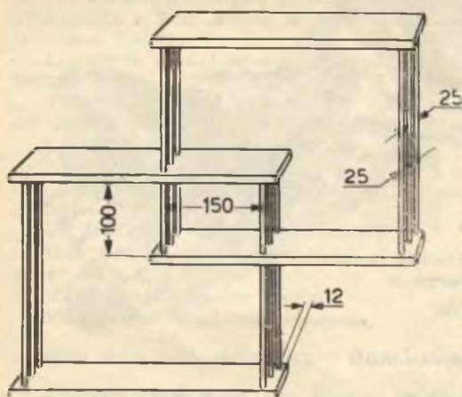
stagionato, dello spessore di mm. 12, della larghezza di mm. 80 e della lunghezza di mm. 380, eseguiremo alle estremità delle medesime fori ciechi di mm. 20 di diametro, profondi mm. 8-10.
