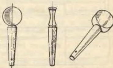
Fig. 9. — Chiavetta per accordatura.
