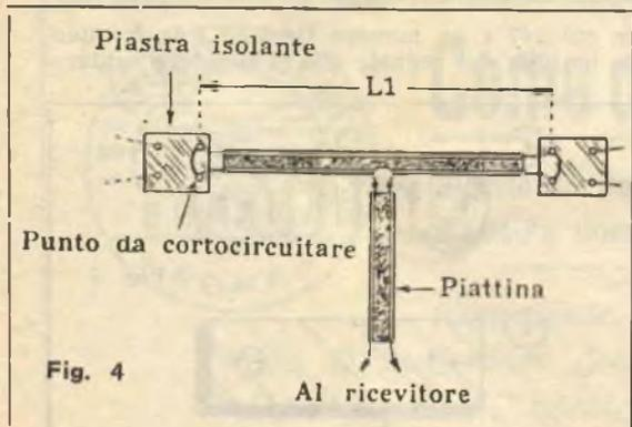
caso costituiti da tubi in rame del diametro esterno di mm. 3-4 — su di una basetta di materiale isolante (fig. 3). Ricordiamo che le due estremità di centro dell'antenna, in corrispondenza cioè del centro di divisione del filo di
