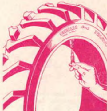
Fig. 2. — Svitare il raccordo mobile della valvola per provocare lo sgonfiamento parziale della camera d'aria.
