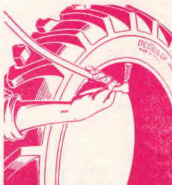
Fig. 3. — Gonfiare con aria alla pressione prescritta.
