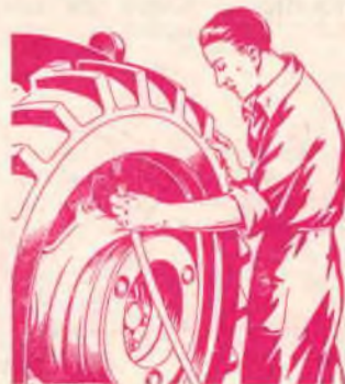
Fig. 3. — Introdurre l'acqua nel pneumatico applicando un comune tubo di gomma sul corpo della valvola.
