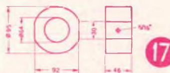
Fig. 8 - ANELLO DI SOSPENSIONE (Part. 17) in ottone.
