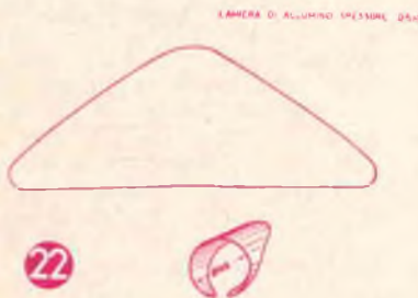
Fig. 10-PARASOLE (Part. 22). In lamiera di alluminio dello spessore di mm. 0,5-1.
