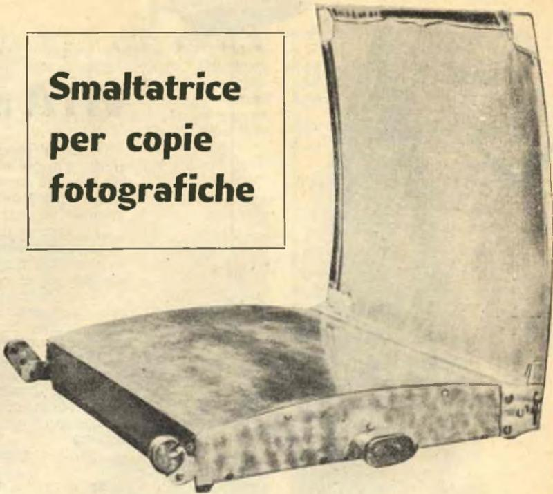
premettendo che la lamiera in alluminio od ottone da usare per la realizzazione dei particolari dovrà avere uno spessore minimo di mm. 3, prenderemo in considerazione dettaglio per dettaglio:
