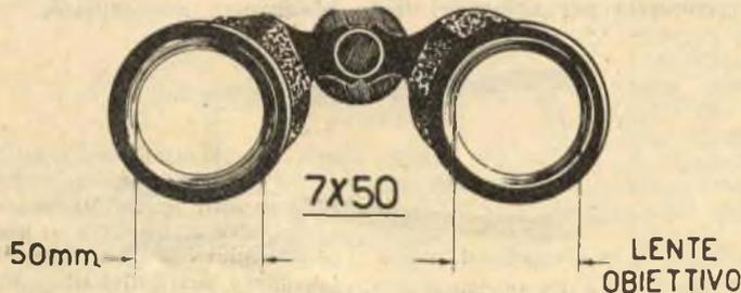
Fig. 7. — L'indicazione 7 x 50 sta ad indicare che il binocolo in esame ingrandisce l'immagine di 7 volte e dispone di una lente d'obiettivo del diametro di mm. 50.
