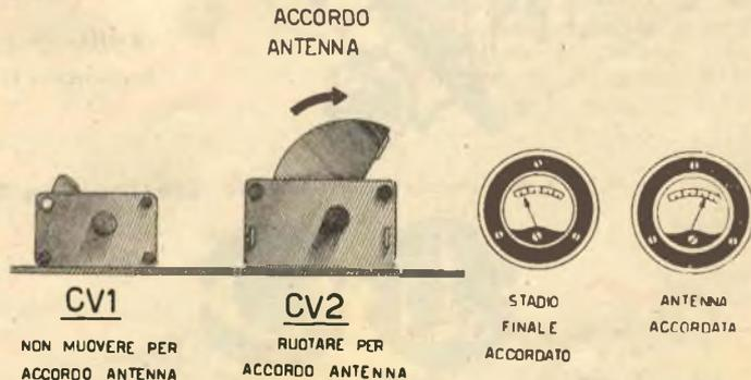
Fig. 18. — Ottenuto il minimo assorbimento, inseriremo l'antenna e ruoteremo CV2 fino a tanto che lo strumento indichi il massimo assorbimento.
