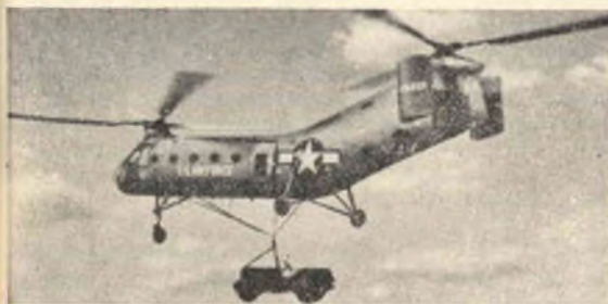
Fig. 7. - Il VERTOL H21 risulta l'elicottero di maggiore introduzione nelle Forze Armate americane. Vero « mulo dell'aria », può venire impiegato in caso di trasporto materiale e trasporto uomini. Nel suo interno trovano sistemazione 20 uomini perfettamente equipaggiati; gli è possibile sollevare carri armati o cannoni su terreno accidentato con l'ausilio di funi d'acciaio.
