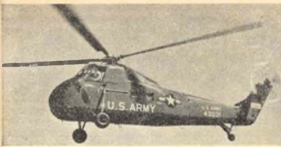
Fig. 6. - L'elicottero da trasporto tipo SIKORSKY S58, in dotazione alle Forze di terra e di mare americane. E' una derivazione migliorata del tipo SIKORSKY S55, differenziandosi da questo per le modifiche apportate alla fusoliera (portello di carico laterale). Può trasportare 1,8 tonnellate di materiale, o 12 uomini perfettamente equipaggiati, con un'autonomia di 160 Km. Con carico ridotto può aumentare l'autonomia fino a 430 Km.; contando su di una riserva supplementare a 1800 Km. (tragitto MILANO-LISBONA, NAPOLI-ALESSANDRIA d'EGITTO).
