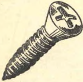
Fig. 4 - Vite PHILLIPS con taglio a croce, che favorisce il centraggio automatico del cacciavite.
