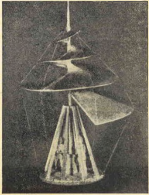
Fig. 1. - In figura appare il modellino, ricavato da disegno di LEONARDO, della vite aerea, o elicottero, che mosso dall'azione combinata di due uomini, avrebbe dovuto, secondo l'inventore, avvitarsi nell'aria innalzandosi.
