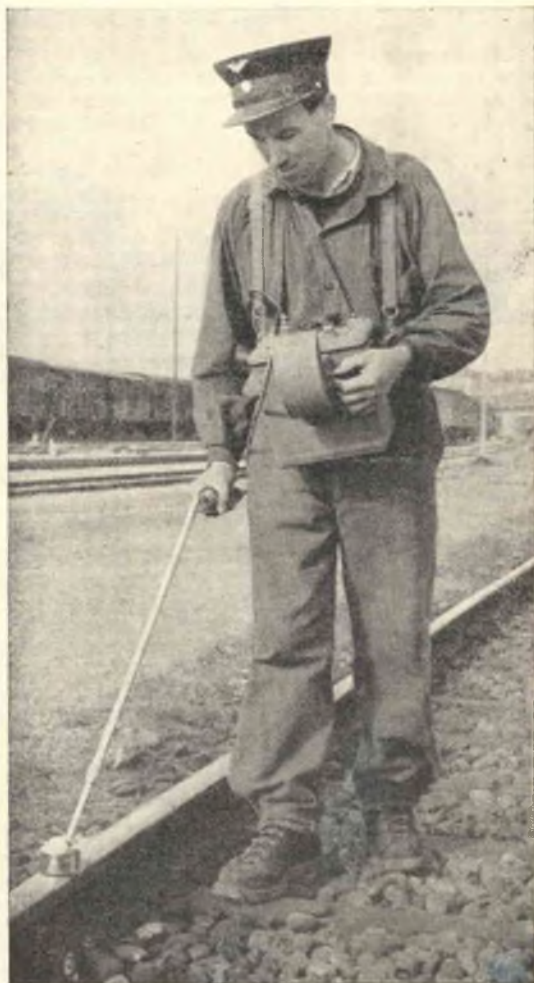
Fig. 4. - Disposizione d'allogamento del pick-up all'interno della custodia metallica.
