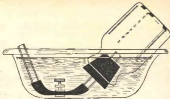
Fig. 8. - L'operazione di chiusura del vaso da marmellate dovrà essere effettuata in immersione
