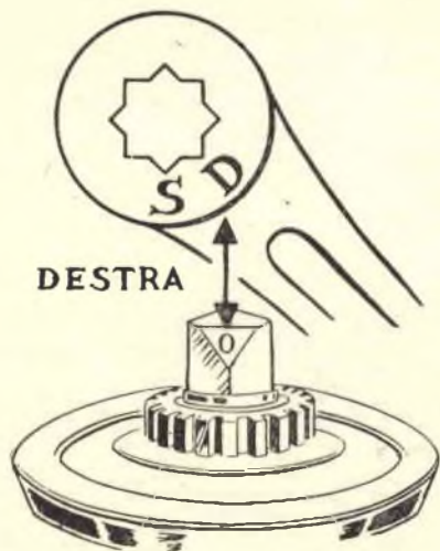
Fig. 8. — Nel caso di montaggi destri, la lettera D, incisa su una delle basi d'appoggio della leva, dovrà coincidere con lo 0 (zero) inciso all'estremità del perno.
