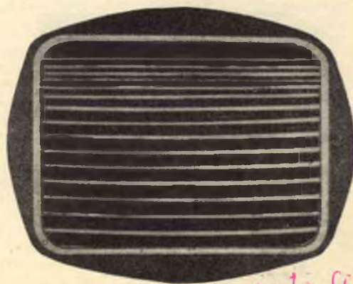
Fig. 5. — Qualora la linearità verticali orizzontale non risulti corretta le barre orizzontali appaiono distanziate irregolarmente. Altrettanto dicasi nel caso della linearità verticale.
