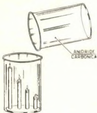
Fig. 6. - Dimostrazione della possibilità di travaso dell'anidride carbonica e della sua impossibilità di mantenere la combustione.
