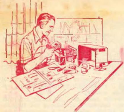
Sottoposto a **intervista orientativa** il proprietario dell'apparecchio passatoci per riparazione e annotatici i difetti rilevati dal medesimo, passeremo alla determinazione del tipo di ricevitore affidato alle nostre cure e cioè ci accerteremo dell'appartenenza di detto o alla serie con valvole alimentate in parallelo, o in serie, o con alimentazione a corrente continua (1ª - 2ª e 3ª categoria di cui alla 2ª puntata).
