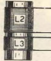
Fig. 3. - Utilizzazione di un supporto in bachelite o cartone.
