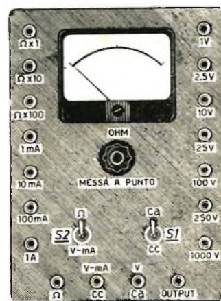
Fig. 15 - Come si presenta il pannello esterno del tester.
