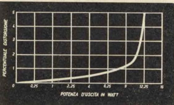
Fig. 4 - Dall'esame del diagramma balza evidente come la massima fedeltà si consegua con potenza d'uscita media.
