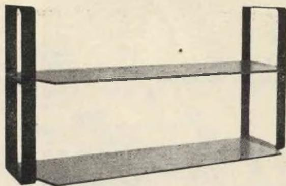
**Fig. 35.** - Montanti in piattina di ferro laccato nero; ripiani in cristallo lucente decorato con scanalature parallele intagliate alla mola; fissaggio alla parete a mezzo viti; larghezza frontale 810 millimetri - profondità 230 - altezza del montante 430 - distanza fra i ripiani 250.
