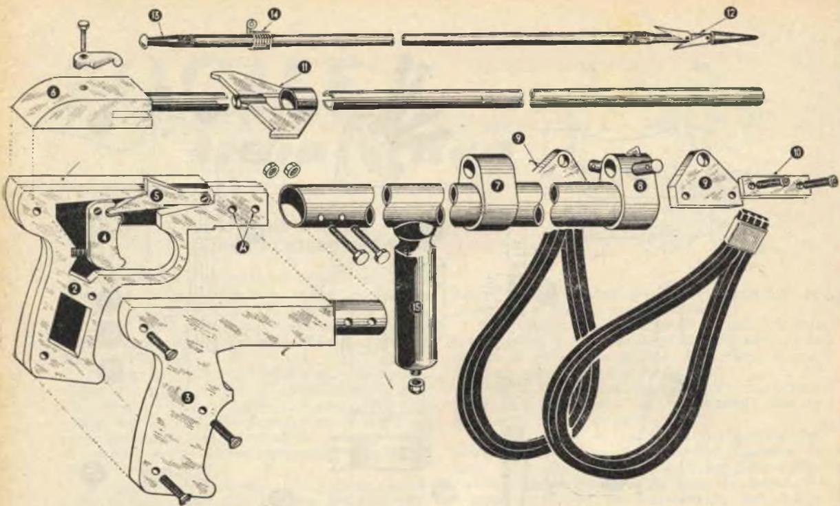
Fig. 2 - Ordine di montaggio dei particolari.
