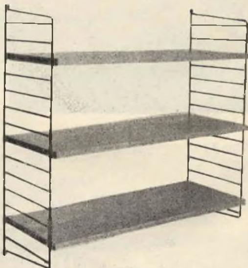
**Fig. 36.** - Montanti in tondino di ferro; ripiani in abete, betulla, olmo o mogano; fissaggio alla parete a mezzo viti. Larghezza frontale mm. 400 o 800 - profondità mm. 200 o 300 - altezza mm. 500 o 750.
