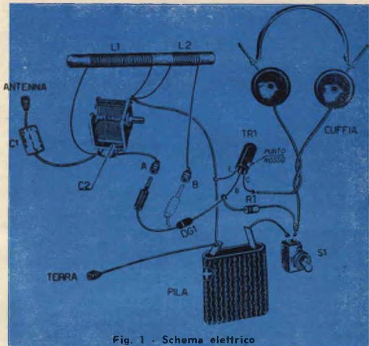
Fig. 1 - Schema elettrico
