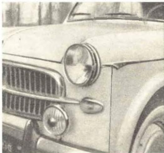
Fig. 14 - Fisseremo il proiettore alla carrozzeria, procedendo all'allineamento perfetto.
