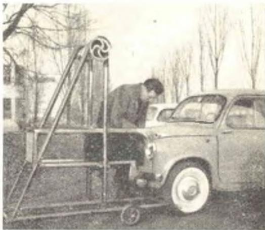
Fig. 17 - Di somma importanza ai fini di un ottimo rendimento dell'asimmetrico risulta l'esatto orientamento a montaggio effettuato, per la qual cosa è consigliabile l'uso del Regloscope in dotazione agli elettrauto.
