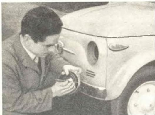
**Fig. 2 - Sulla FIAT 500 le operazioni di sostituzione del gruppo ottico si presentano particolarmente semplici. Si smonta il faro e si toglia il gruppo ottico...**
