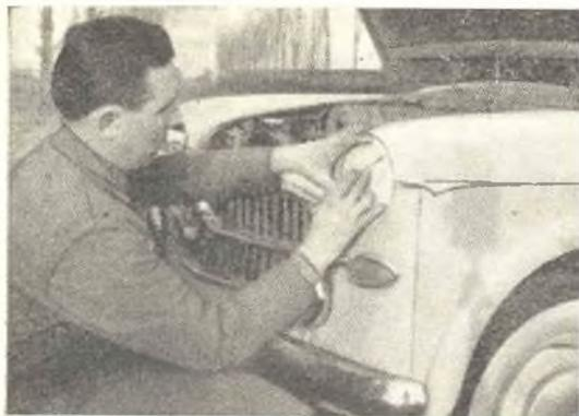
**Fig. 10** - In determinati casi è possibile sostituire l'intero proiettore esistente normale con proiettore asimmetrico di diametro maggiore, coll'evidente vantaggio di accrescere notevolmente il volume di luce a disposizione. In tal caso utilizzeremo, per una perfetta riuscita dell'operazione, la mascherina di cui a figura 16.
