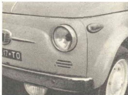
**Fig. 4 - Si rimonti il faro curandone l'allineamento.**
