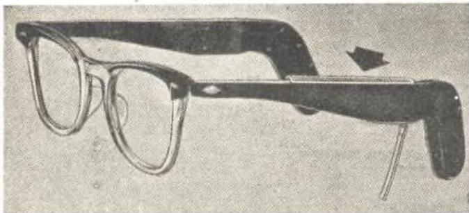
La ZENITH RADIO CORPORATION ha ultimamente lanciato sul mercato occhiali per deboli d'udito, provvisti di pila solare per l'alimentazione dell'amplificatore a transistori.
