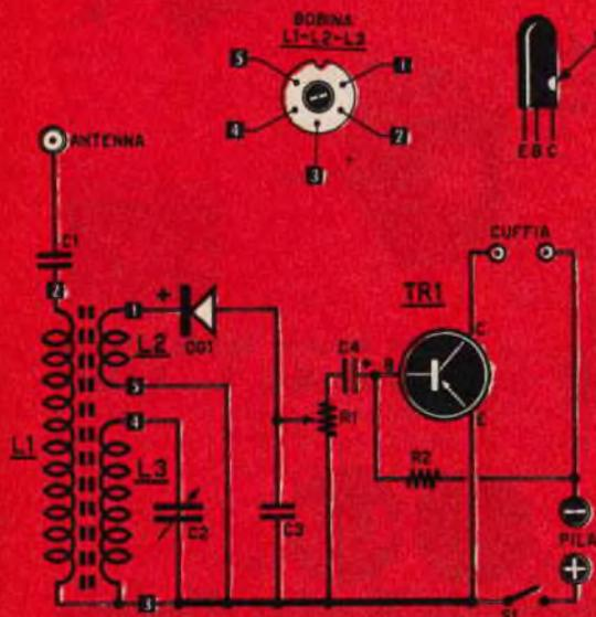
Fig. 1 - Schema elettrico del ricevitore
