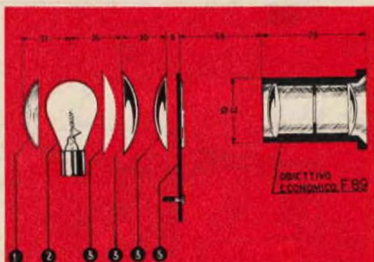
Fig. 1 - Sistema ottico di tipo economico. 1) Specchio alluminato; 2) lampada d'auto; 3) lenti condensatore (la linea a tratto indica una terza lente, utilizzabile nel caso si intenda aumentare la luminosità del complesso; 5) telaio porta-diapositive.
