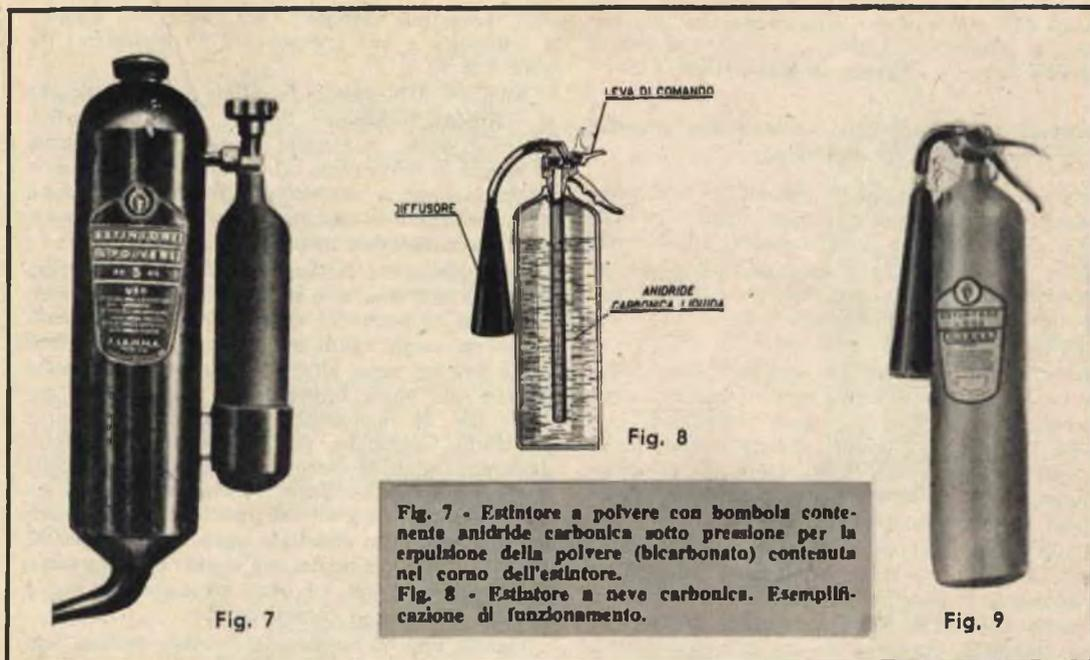
Fig. 7 - Estintore a polvere con bombola contenente anidride carbonica sotto pressione per la espulsione della polvere (bicarbonato) contenuta nel corno dell'estintore.
