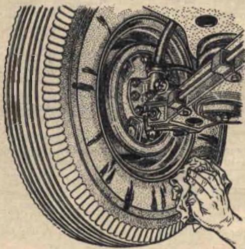
Non tutti si rendono conto di come risulti deleteria l'azione del grasso o dell'olio sulle coperture delle macchine.
