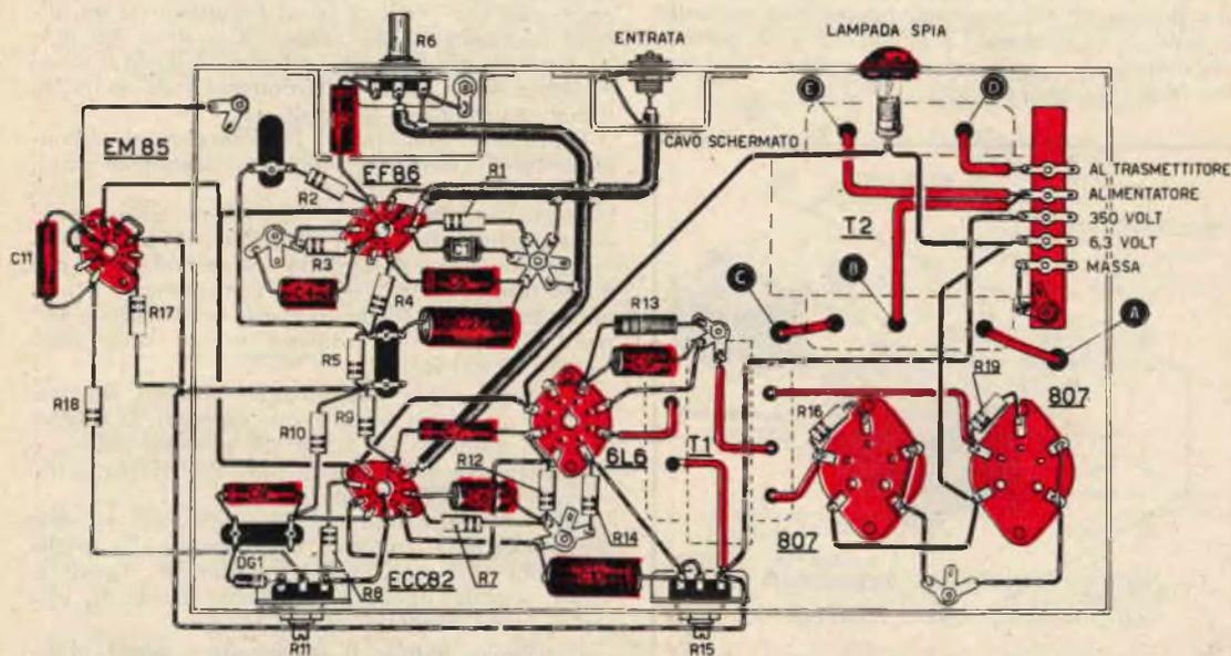
Fig. 2 - Schema pratico dell'amplificatore. Nel montaggio al ferrù presente di non sistemare sul medesimo asse i nuclei dei trasformatori T1 e T2 al fine di non creare inneschi di BF. Tener pure presente che i collegamenti
