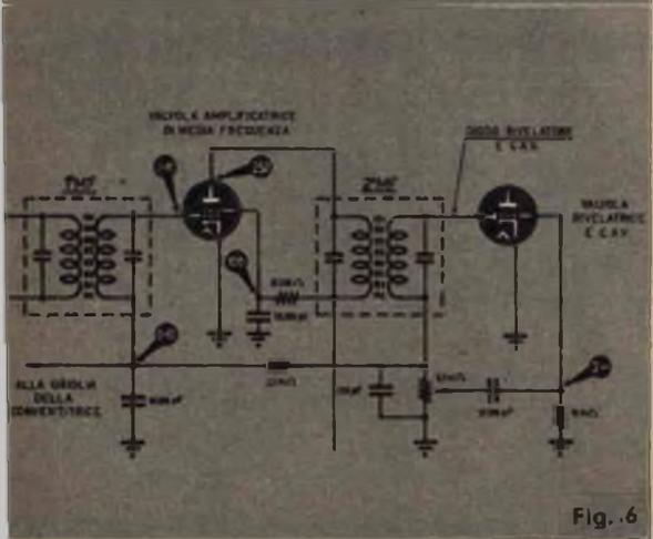
da 20.000 a 50.000 ohm, interruzione causata frequentemente dal cortocircuito del condensatore di disaccoppiamento (50.000 pF) sistemato fra griglia e massa.
