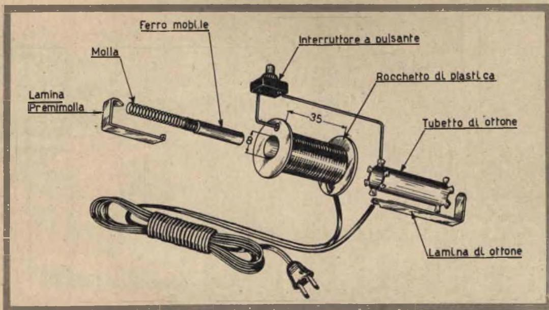
lamina di contatto e pure essa assicurata in posizione a mezzo nastro isolante.
