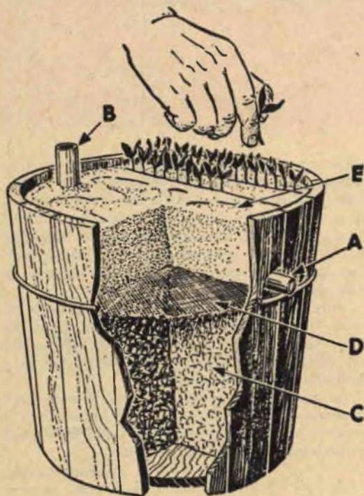
(lettera B); riempite il mastello con ghiaia (lettera C) fino a sfiorare il livello inferiore del primo tubo. Coprite con un telo grezzo (lettera D) e colmate il vaso con terra (lettera E).
