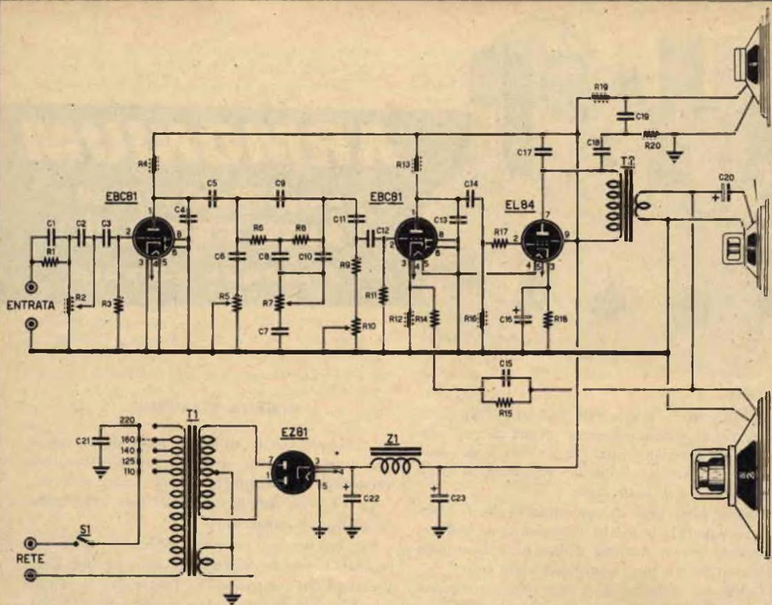
Fig. 1 - Schema elettrico.
