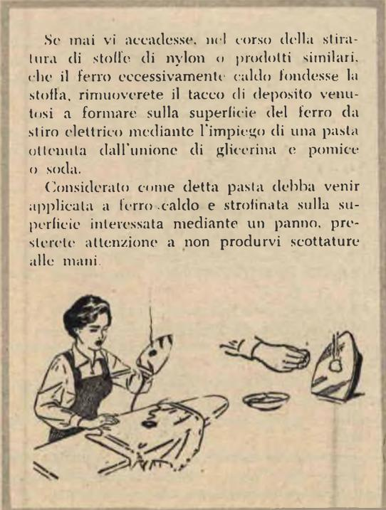
Se mai vi accadesse, nel corso della stiratura di stoffe di nylon o prodotti similari, che il ferro eccessivamente caldo fondesse la stoffa, rimuoverete il tacco di deposito venutosi a formare sulla superficie del ferro da stiro elettrico mediante l'impiego di una pasta ottenuta dall'unione di glicerina e pomice o soda.
