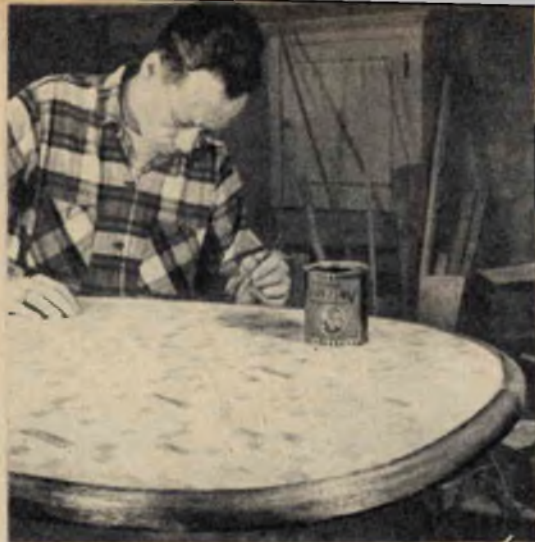
Fig. 11 - Per la definitiva finitura dell'orlatura useremo vernice a smalto o lucideremo a tampone.
