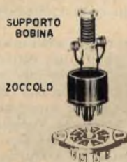
Fig. 4 - Sia la bobina d'aereo che quella oscillatrice verranno montate su uno zoccolo octal in bachelite.
