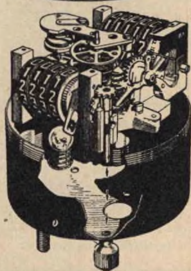
Fig. 4 - Il tachimetro a lancetta è il tipo più comune. Il disco di alluminio indotto è direttamente collegato alla lancetta. In figura il tachimetro smontato completo di contattometri ed il tipo semplificato.
