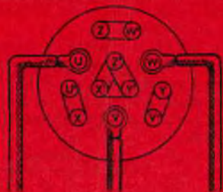
Fig. 11 - Morsettiera di tipo circolare usata dalla MARELLI, FIMET, CGE, PELLIZZARI, S. GIORGIO, BROWN-BOVERI e altri ancora. Che la morsettiera risulti circolare, ovale o rettangolare non ha importanza, tanto è vero che la disposizione dei morsetti è sempre la stessa. Ogni morsettiera a 12 morsetti è dotata di 9 linguette in ottone ricotto che servono per effettuare i vari collegamenti indicati a figura 5. Necessita però tener presente che nei tipi di morsettiera riportati a figura 5 (colonna a sinistra), il collegamento per il triangolo zig-zag ( \Delta Z ) non si può eseguire con le linguette di cui è corredata la morsettiera e che in casi del genere si fa ricorso a spezzoni di filo ben isolato, che dovrà venire strettamente avvitato ai morsetti per mezzo degli appositi bulloni e relativi dadi. U-V-W rappresentano i morsetti ai quali vengono connessi i tre fili della linea.
