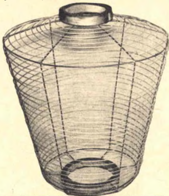
Fig. 4. - Gabbia in filo di ferro interamente saldata a stagno da ricoprirsi in finta pergamena e che costituisce il paralume della lampada.
