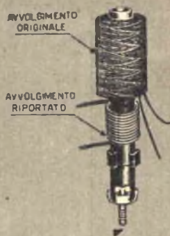
Fig. 5 - Bobina normalmente usata in televisione e adattata, mediante il secondo avvolgimento, per l'impiego nell'apparato ricevitore-trasmittitore.
