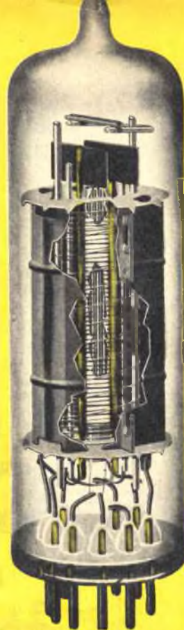
Fig. 12 - Spaccato di una moderna valvola elettronica. Tutti gli elementi contenuti sono ben visibili a partire dal filamento che costituisce l'elettrodo centrale fino alla placca che è l'ultimo elettrodo ed è quello che racchiude tutti gli altri.
