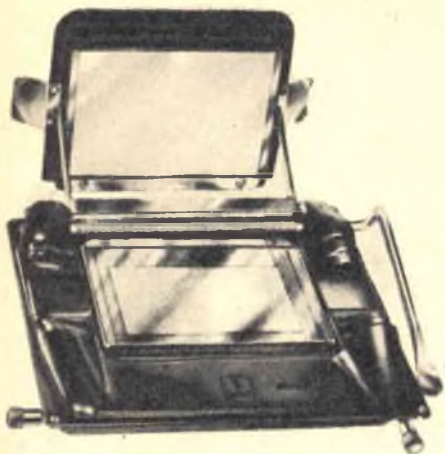
Fig. 14 - Porta-negativo costituito da due vetri otticamente lavorati.
