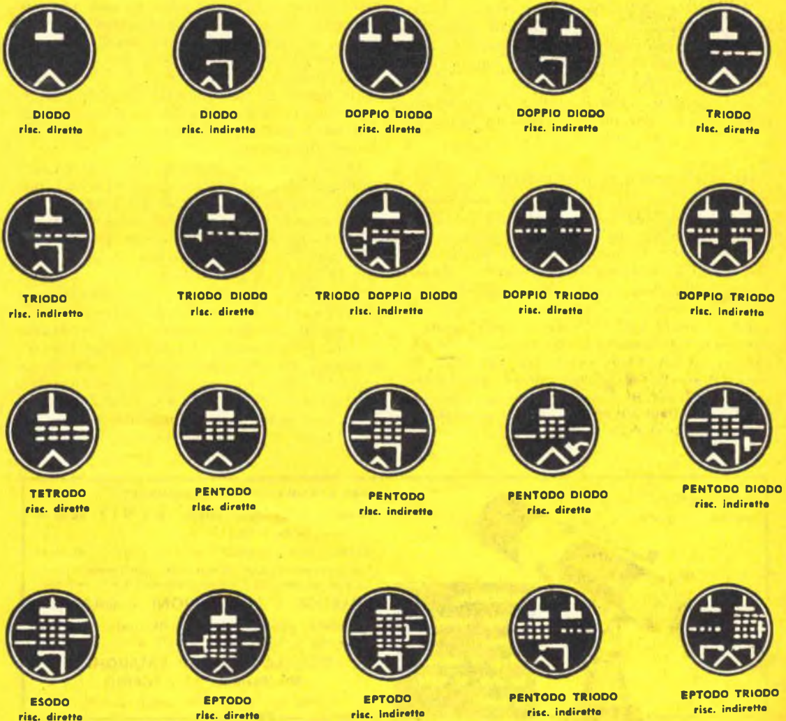
Fig. 14 - Simboli grafici delle valvole più comuni attualmente in uso impiegati negli schemi radio-elettrici.
