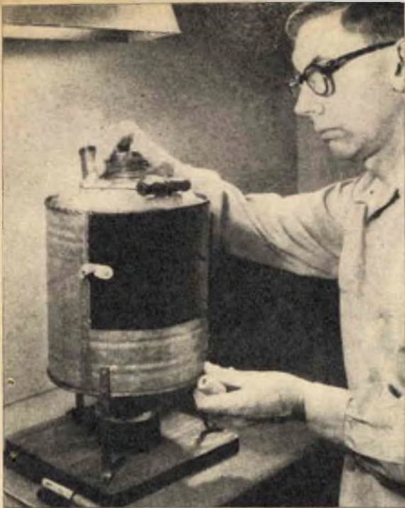
Fig.1 - Un vecchio bidone, opportunamente lavorato, e una «candela» elettrica costituiscono il piccolo forno adatto per cuocere dei lavoretti in ceramica o per ottenere una verniciatura a fuoco.
