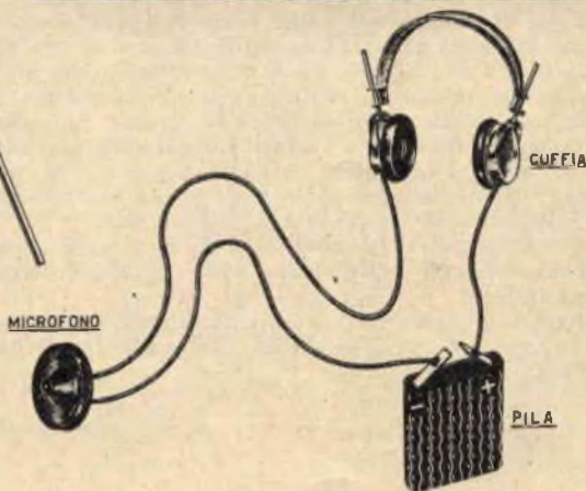
Fig. 3 - La parte elettrica dell'esploratore subacqueo è costituita da un microfono a carbone, da una cuffia e da una pila. Soltanto il microfono è racchiuso nel recipiente ed è destinato all'affondamento. La pila e la cuffia rimangono in superficie.
