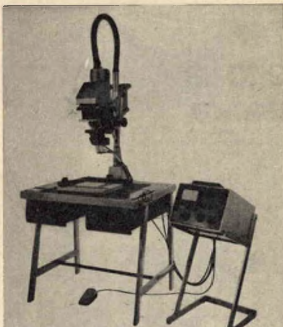
Ingranditore automatico Ferrania per il colore. Misura automaticamente le dominanti di colore e dà la giusta esposizione. È dotato di un vero cervello elettronico (a destra nella figura).
