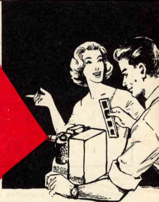
Fig.1 - La scatola del proiettore può essere costruita in legno o cartone. Le diapositive sono contenute in un telaietto costituito da due lastre di vetro, il cui spessore complessivo dev'essere uguale a quello della larghezza delle guide di scorrimento.
