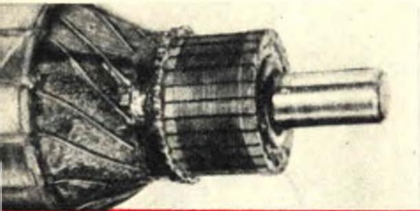
*Fig.2 - Chi sostituisce le spazzole controlli sempre lo stato del collettore: esso potrebbe essere unto dalla polvere di carbone lasciata dalle spazzole o, peggio, essere consumato. In questi casi occorre levigare la superficie e renderla uniforme con carta smeriglio.*
