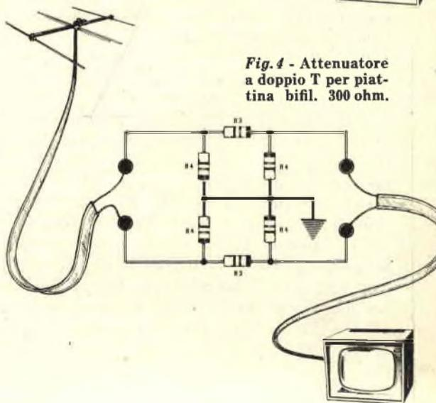
**Fig. 4** - Attenuatore a doppio T per piattina bifil. 300 ohm.
