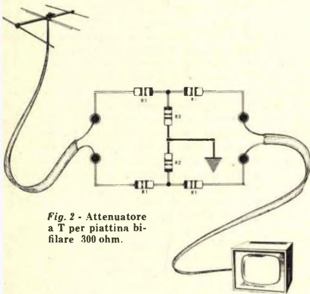
**Fig. 2 - Attenuatore a T per piattina bifilare 300 ohm.**
