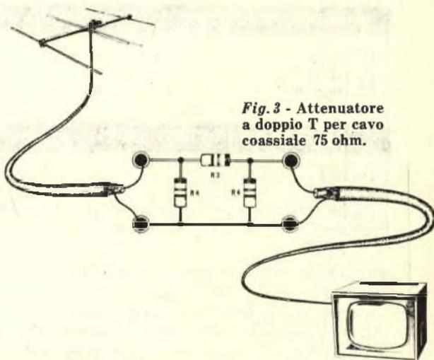
**Fig. 3** - Attenuatore a doppio T per cavo coassiale 75 ohm.
