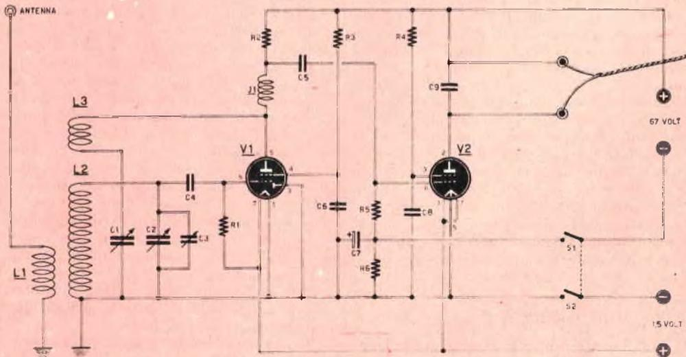
Il controllo della reazione è ottenuto mediante il condensatore C1 per il quale, nell'elenco componenti, è indicato il valore di 290 pF. Abbiamo consigliato questo valore perchè, essendo difficile trovare in commercio un variabile di capacità intorno ai 300 pF, il lettore potrà acquistare il tipo O/108 della G.B.C. che è un variabile a due sezioni (130 + 290 pF) e di cui si potrà impiegare soltanto la sezione maggiore.
