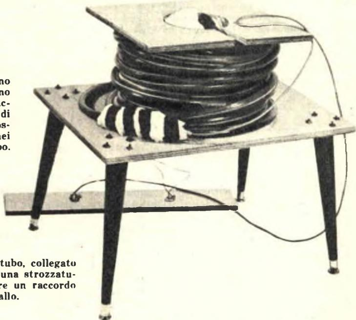
Fig. 8 - Cercate di evitare che il tubo, collegato all'imbuto possa piegarsi, creando una strozzatura; allo scopo consigliamo di usare un raccordo di tipo idraulico in plastica o metallo.
