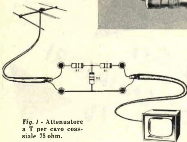
**Fig. 1 - Attenuatore a T per cavo coassiale 75 ohm.**
