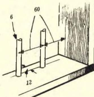
Fig. 1 - I tondini in legno o in tubo fissati nel primo e nel secondo vano, devono essere applicati alla distanza di 60 millimetri l'uno dall'altro.
