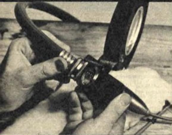
*Fig. 11* - Per unire il microfono all'estremità del tubo di gomma si può far uso di un raccordo o di un piccolo imbuto fissandolo con nastro adesivo; il tutto andrà poi ricoperto con cotone e avvolto in un manicotto di tessuto.
