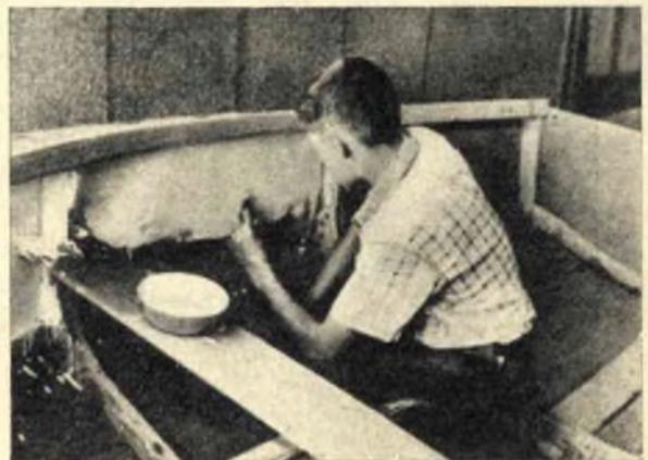
**Fig.6** - Le operazioni di impermeabilizzazione vanno eseguite nella parte interna e in quella esterna della barca. Prima, però, di passare la cementite e le vernici speciali per scafi le superfici dovranno essere accuratamente scartavstrate.
