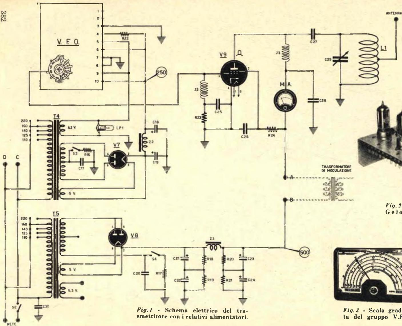
Fig. 1 - Schema elettrico del trasmettitore con i relativi alimentatori.
