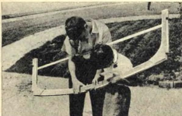
**Fig. 2** - L'ordinata media, rappresentata in figura, è quella che misura la massima larghezza, che corrisponde poi alla larghezza massima della barca. La parte ricurva è in legno di 5 cm. di spessore e i due tratti laterali sono alti 40 cm.
