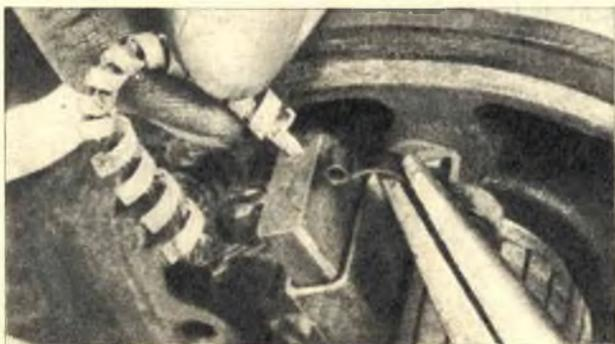
*Fig. 1 - Quando si toglie una spazzola, o per sostituirla o per pulire il portaspazzole, non estraetela mai tirando il filo conduttore che potrebbe rompersi, ma sollevate sempre con una pinzetta la molla di pressione.*
