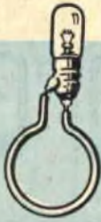
Fig. 7 - La spira sonda è costituita da una lampadina da 6-12 volt alle cui estremità vengono saldati i terminali di una spira di filo di rame di diametro 1 millimetro.
