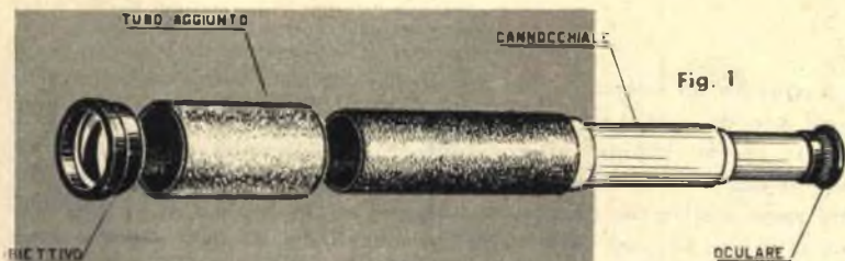
Fig. 1 - Il telescopio di impiego terrestre, per essere adattato alle osservazioni astronomiche, dovrà essere allungato aggiungendo nella sua parte anteriore un tubo di cartone.
