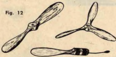
Fig. 12 - Tipi di elica. Da notare l'elica monopala che si vale di un contrappeso per bilanciarsi.
