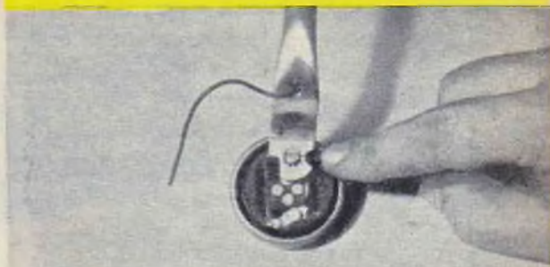
Fig. 4 - Nel fissare il manico al microfono o all'auricolare della cuffia occorre escogitare un sistema che non permetta al componente di ruotare su se stesso.
