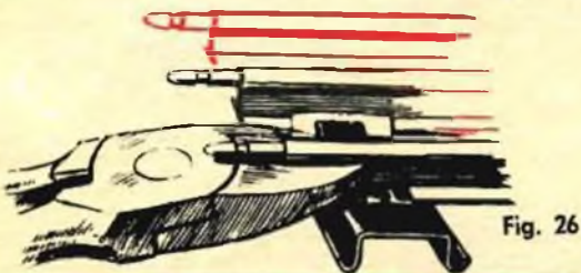
Fig. 26 - Cercate che i terminali della rotaia siano sempre ben allineati.
