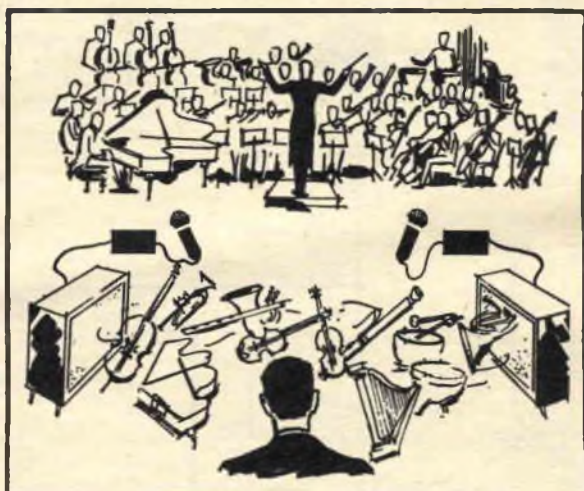
Fig. 3 - In un amplificatore stereofonico, all'altoparlante di destra verranno inviati solamente quei suoni che nella registrazione furono emessi dagli strumenti di destra, viceversa per quello di sinistra. Si avrà così l'illusione di avere nella stanza l'orchestra.
