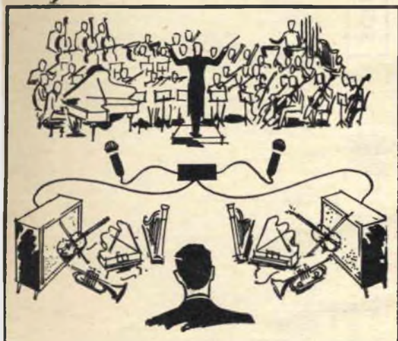
Fig. 2 - Anche se abbiniamo all'uscita di un amplificatore due altoparlanti, i suoni riprodotti, essendo identici sia per l'amplificatore di destra che per quello di sinistra, non si riuscirà a comprendere la disposizione degli strumenti nell'orchestra.
