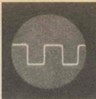
Fig. 3—Il segnale della placca della seconda sezione triodica della 12AT7 ha già assunto una forma perfetta e può essere usato per pilotare il TV
