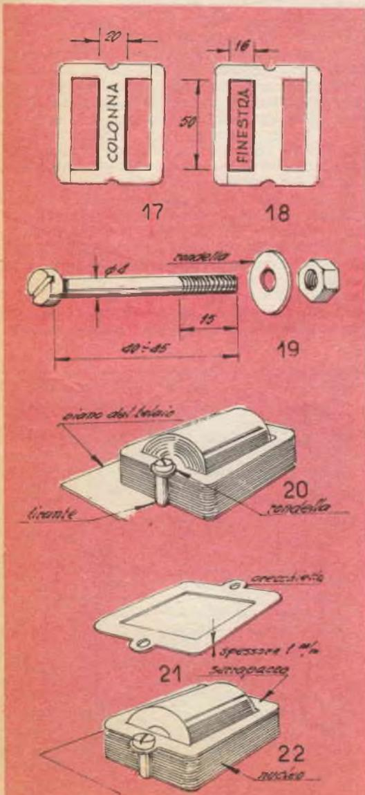
d) - Il **sistema di fissaggio** consta semplicemente, per questo trasformatore, di un paio di bulloni con rondella...
