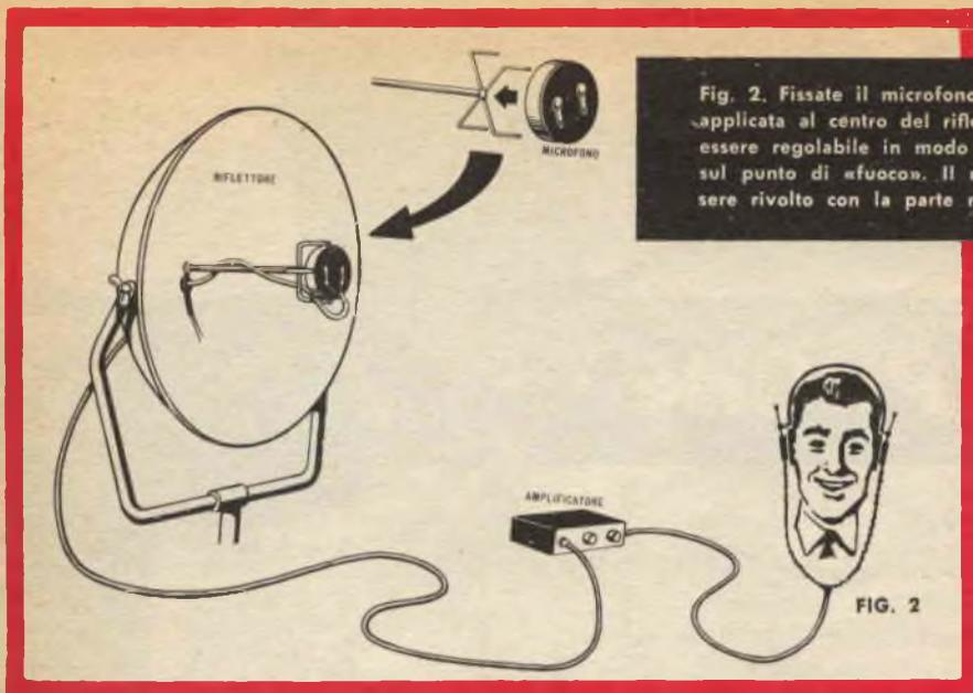
Fig. 2. Fissate il microfono piezoelettrico sopra ad un'asta applicata al centro del riflettore. E' ovvio che l'asta dovrà essere regolabile in modo da poter collocare il microfono sul punto di «fuoco». Il microfono dovrà ovviamente essere rivolto con la parte ricevente verso il riflettore.
