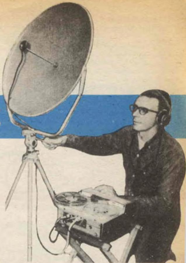
Anche il diametro della superficie stessa avrà la sua importanza; in particolare più ampio sarà il diametro, più acuta sarà la sensibilità del complesso.
