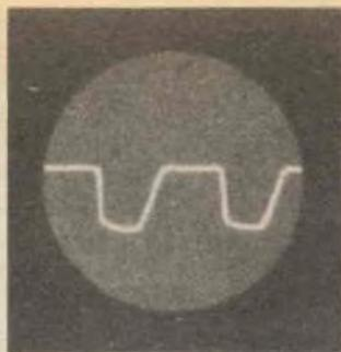
Fig. 2—All'uscita della prima sezione della 12AT7 il segnale ha quasi assunto la caratteristica forma di un segnale a onda quadra sincronizzato su 625 linee
