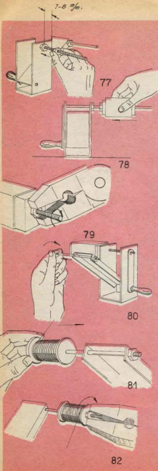
(77) ...poi avvittiamo a mano il secondo dado fino a portarlo ad una distanza di 7÷8 mm dalla fiancata della bobinatrice...
