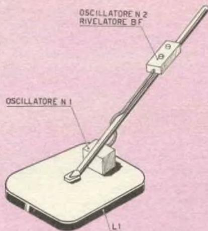
Fig. 5. Sopra ad un manico di scopa fissate in basso la bobina L1 e, dentro l'apposita scatola, l'oscillatore N1, mentre a portata di mano applicherete con due viti la cassetina che conterrà l'oscillatore N2 ed il rivelatore.
