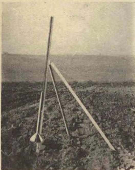
La rampa di lancio che occorre costruire e che servirà per qualsiasi altro razzomodello.
