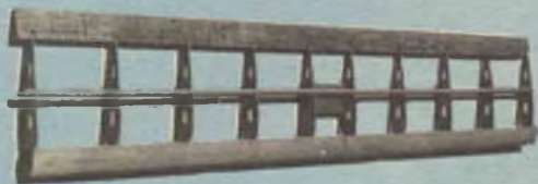
Fig. 1 - Prima fase di costruzione dell'ala: le centine, allineate sul piano di montaggio, vengono unite ai bordi di entrata e di uscita, nonché ai longheroni. Numerosi spilli, opportunamente disposti, mantengono le parti ben ferme.
