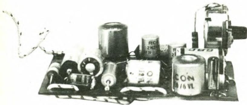
Un condensatore di capacità modesta, come quello da noi impiegato deriva a massa solo le frequenze più alte, mentre la sua bassa reattanza capacitiva blocca le frequenze basse, le quali sono pertanto controreazionate, e risultano in definitiva amplificate in minor misura delle alte.
