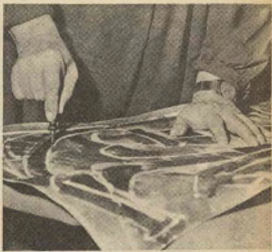
Fig. 2 - Con un temperino si incide il contorno. Spargendo un velo di polvere di carbone sul foglio si ha la traccia del modello sul tavolo sottostante.
