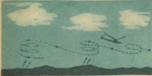
FIG. 4 - ...In corrispondenza di formazioni cumuliformi e sotto ad esse si formano correnti di aria calda e quindi ascendente che possono anch'esse essere usate da un aliante per ottenere guadagni di quota
