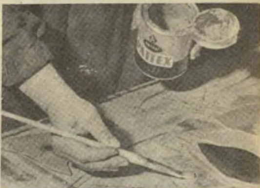
Fig. 5 - Si sparge a piccole dosi la colla sui pezzi da inserire e sul tavolo.
