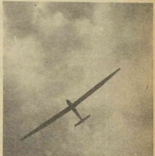
Un aliante in volo; notare il particolare, comune a tutti gli alianti, dell'apertura alare molto ampia rispetto alle altre dimensioni dell'aereo.
