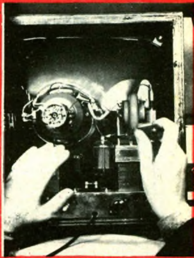
Fig. 5 - Così si scarica a massa il contatto della verifica. - Fig. 6/7 - NON usare il cacciavite per rivelare l'EAT.
