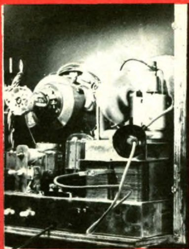
Fig. 5 - Così si scarica a massa il contatto della verifica. - Fig. 6/7 - NON usare il cacciavite per rivelare l'EAT.
