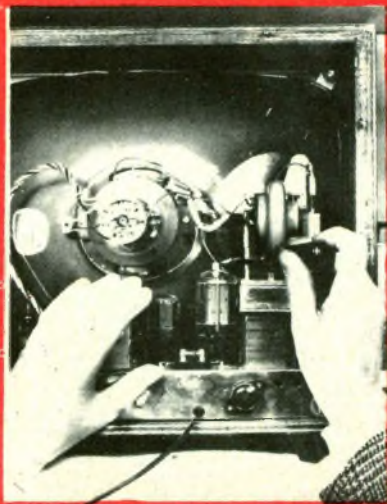
Fig. 5 - Così si scarica a massa il contatto della verifica. - Fig. 6/7 - NON usare il cacciavite per rivelare l'EAT.
