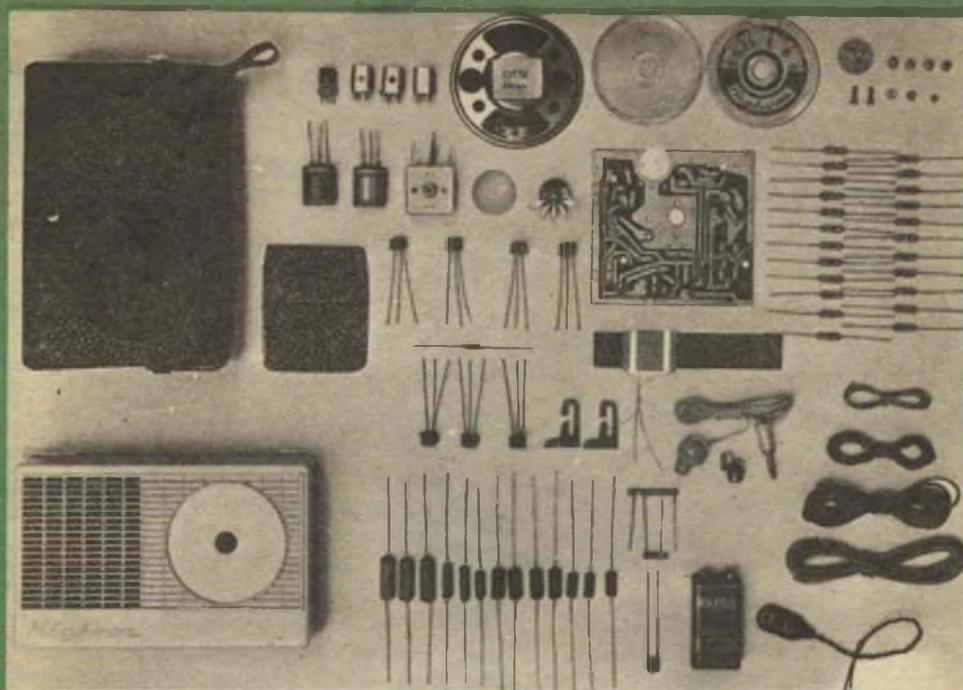
LA SCATOLA DI MONTAGGIO per ricevitore a 7 transistori, supereterodina, che si monta col solo aiuto di un saldatore.
