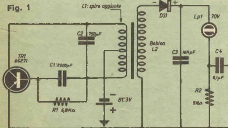
Il « trasformatore » che eleva la tensione alternata RF generata dal transistor, è in pratica una « bobina di linearità » per TV alla quale sono state aggiunte 30+30 spire che costituiscono il « primario ».
