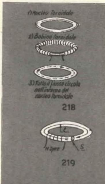
si ottiene disponendo lungo il percorso del flusso i **materiali magnetici**. in entrambi i casi, agli effetti della f.e.m. autoindotte, è come se si fosse aumentato il flusso generato a parità di corrente col risultato di elevare il valore del coefficiente L.
