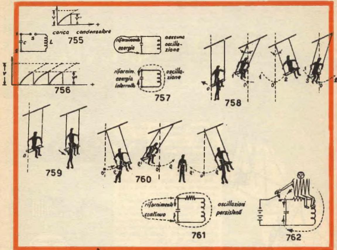
tro e ha inizio la scarica oscillante; dallo stesso momento ha inizio la ricarica del condensatore. Naturalmente bisogna regolare  $R_{11}$  e  $L_{11}$  in modo che il tempo di carica, fino a  $V'$ , sia maggiore del tempo in cui si effettua la scarica oscillante e che quindi s'interrompa l'arco fra lo spinterometro.
