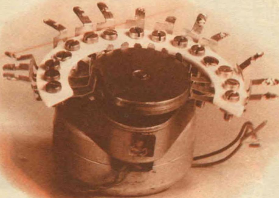
di lampade accesa si sposti lungo la fila in corrispondenza delle spazzole a contatto con il rotore.
