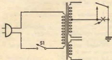
Si tratta solo di un interruttore (vedere lo schema) collegato fra il centro del secondario AT del trasformatore di alimentazione e la massa.
