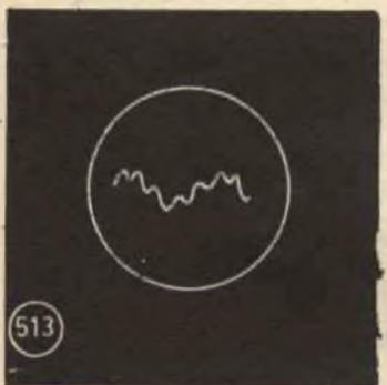
tico esterno al televisore, quale può essere un apparecchio elettrico in funzione, una insegna al neon accesa, agisce da sorgente di disturbo nella ricezione. E non è sempre agevole nemmeno distinguere a prima vista un difetto proveniente da guasto interno del televisore da un disturbo proveniente dall'esterno, come pure
