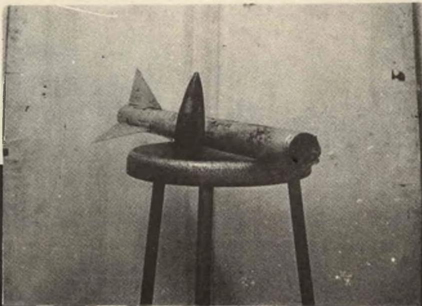
Fig. 8 Ogiva e razzo recuperati dopo il lancio (Sono visibili gli effetti del calore sulla verniciatura. Il prototipo montava alette di tipo triangolare.
