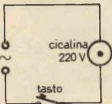
E' ovviamente il più semplice anche realizzabile dato che non occorrono neppure batterie di alimentazione.
