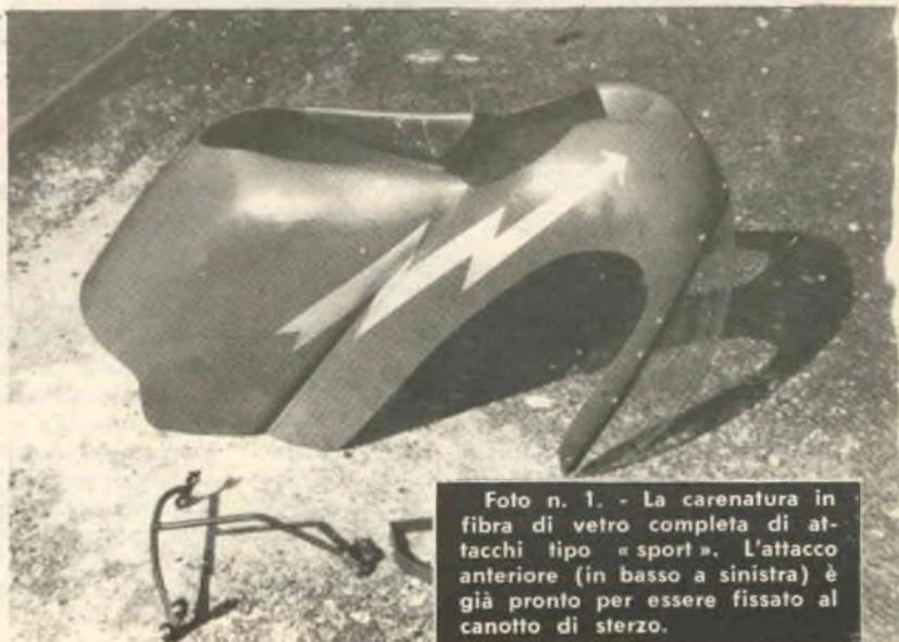
Foto n. 1. - La carenatura in fibra di vetro completa di attacchi tipo « sport ». L'attacco anteriore (in basso a sinistra) è già pronto per essere fissato al canotto di sterzo.
