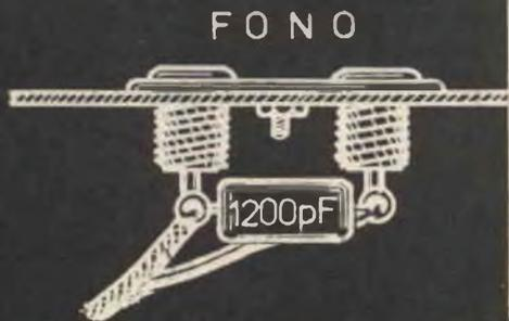
**E**qualizzare un complesso sonoro significa modificare la curva di risposta del rivelatore ed adattarla a quella d'ingresso dell'amplificatore di bassa frequenza.
