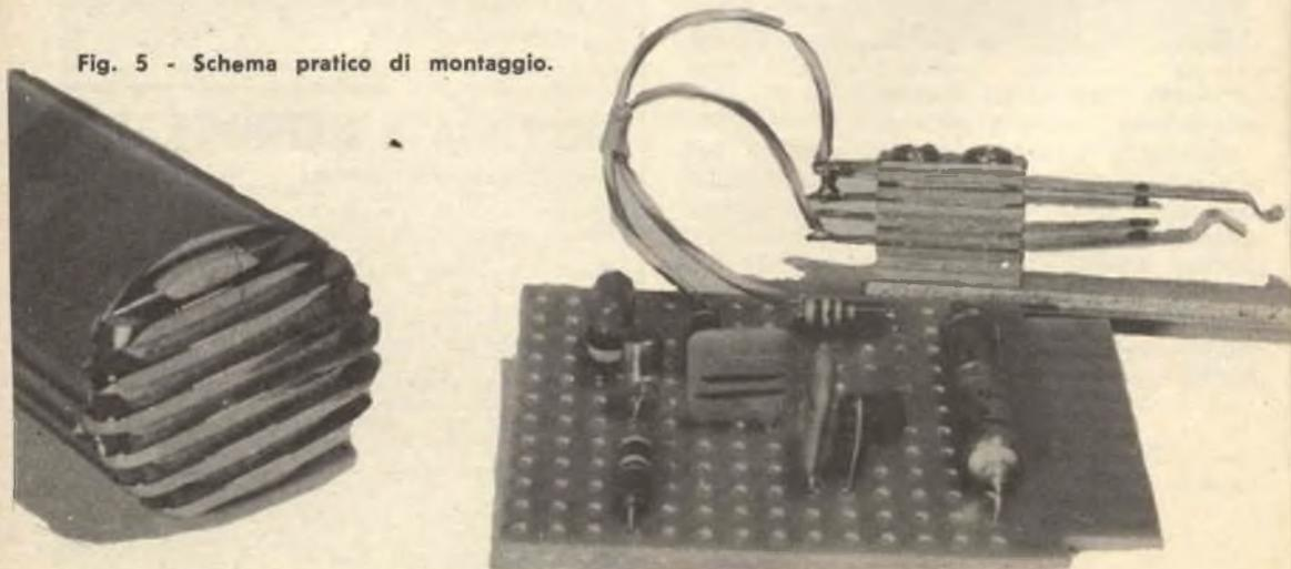
plificatore: si tratta di un circuito stampato convenzionale che, come ogni suo simile, richiede una saldatura rapida, un calore non eccessivo, un accurato controllo di ogni parte prima del fissaggio definitivo.
