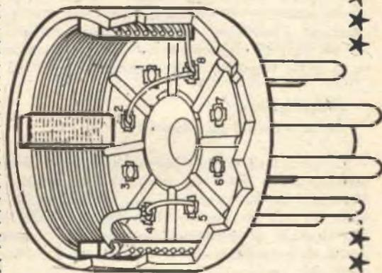
Per irrigidire l'avvolgimento si usano delle strisciole di plastica, che saranno incollate sulle spire usando mastice per alta frequenza.
