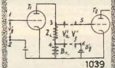
(1040) Per compensare la diversità delle tensioni medie si può disporre una batteria di tensione e polarità opportuna, detta contro-batteria.
