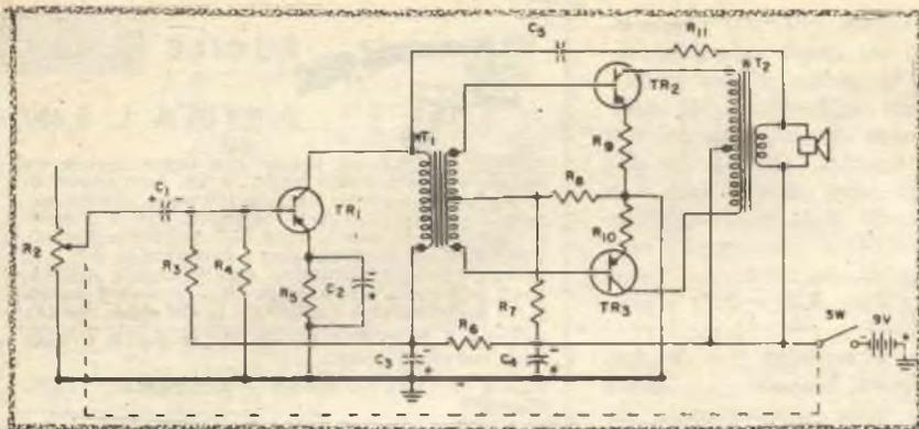
**Fig. 1 -** Ecco lo schema di un tipico ricevitore supereterodina giapponese. Sovente, questo genere d'apparecchi cessa di funzionare perchè i condensatori elettrolitici posti in parallelo all'alimentazione generale perdono d'isolamento, cortocircuitando la pila.
