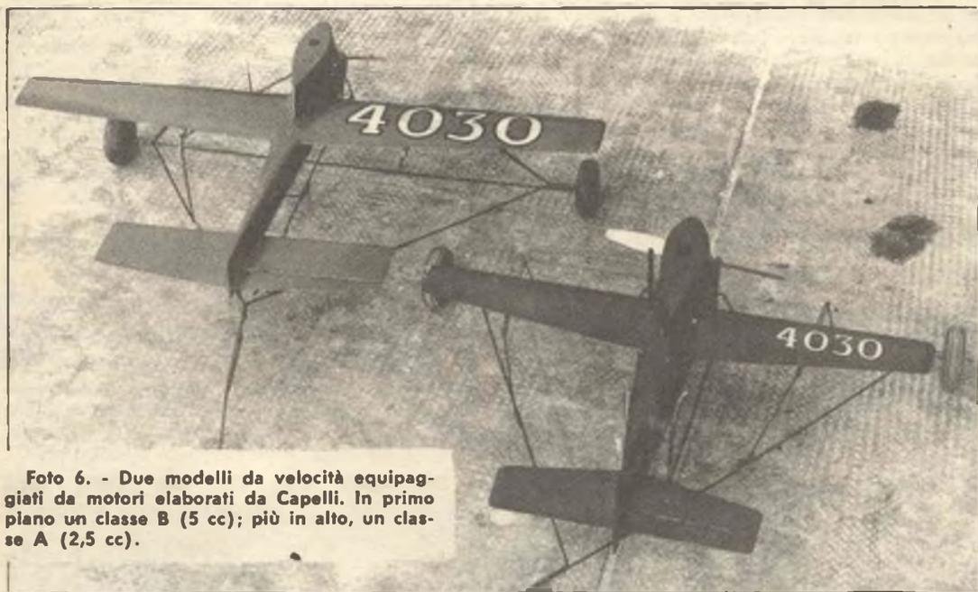
Foto 6. - Due modelli da velocità equipaggiati da motori elaborati da Capelli. In primo piano un classe B (5 cc); più in alto, un classe A (2,5 cc).
