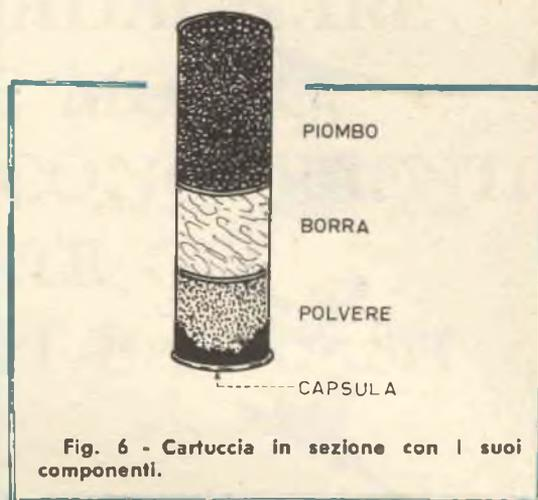
Fig. 6 - Cartuccia in sezione con i suoi componenti.
