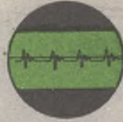
Fig.4-Immagine delle 4 candele avendo l'asse dei tempi dilatato.
