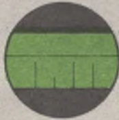
Fig.7-Immagine nel caso di una candela sporca.
