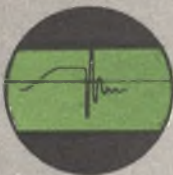
Fig.12-Tempo di apertura delle puntine eccessivo (asse dei tempi dilatato).
