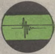
Fig.3-Immagine prelevata su di una candela avendo l'asse dei tempi dilatato.
