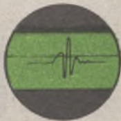
Fig.13-Tempo di apertura delle puntine normale (asse dei tempi dilatato).
