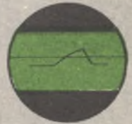
Fig.14-Oscillogramma di un condensatore in cattivo stato.
