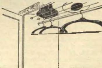
Un piano per cappelli od altri oggetti di piccolo peso può esser facilmente aggiunto ad ogni armadio, tendendo un conveniente numero di fili resistenti tra delle viti ad occhiello fissate nei fianchi del mobile, al di sopra del bastone porta-grucce.
