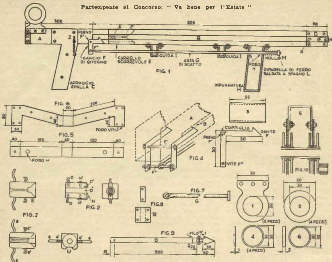
Le parti che costituiscono questo fucile sono: la canna (A), l'appoggio a spalla (C), il tassello fisso (D), il tassello mobile (E), il grilletto (F), l'impugnatura (H), l'asta di scatto (G), le guide (I), il mulinello (M), l'arpione (P), il rinforzo (R), la sicura (Z).
