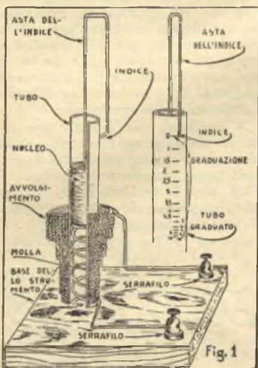
Provvedersi di un tubo di cartone lungo almeno 12 cm. e col diametro di 1 cm. o più. Fissarlo ad una tavoletta di legno sulla quale vanno pure avvitati due serrafili. Avvolgere attorno al tubo una decina di metri di filo da 10÷20 decimi coperto; l'avvolgimento va fatto in più strati, a cominciare dal fondo e per una
