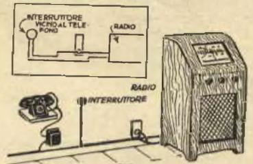
Stanchi di correre ad abbassare la radio ogni volta che il telefono squallava, abbiamo provveduto a montare un interruttore vicino al telefono, connettendolo in serie con la linea della radio, cosicché possiamo ora spingere l'apparecchio senza allontanarci dal telefono.
