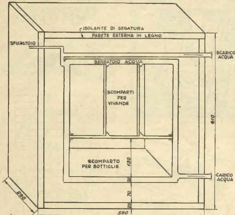
Non c'è ghiaccio, è vero, ma la temperatura interna, che in questo recipiente è possibile mantenere intorno ai 10 gradi, permette la buona conservazione di vivande in genere e verdure in particolare, anche durante i calori dell'estate, e per giunta senza che si debba spendere un centesimo.
