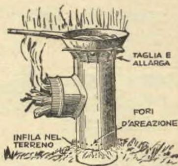
Questa stufa da campo ha il solo guaio di essere un po' ingombrante, ma tale difetto è compensato dall'estrema leggerezza e dall'estrema semplicità, in quanto un giunto da tubo di stufa, meglio se di diametro piuttosto grande, è tutto quello che occorre.
