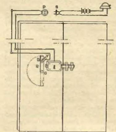
luce ed un trasformatore da campanelli), circuito nel quale si trova inserito il campanello di allarme.
