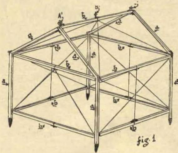
Esso si compone di 2 telai separati, formati ciascuno da 4 aste unite tra loro a mezzo di 3 cerniere che ne permettono il ripiegamento, in modo da rendere il tutto trasportabile facilmente. Nove aste, composte ciascuna di due elementi uniti a mezzo di una cerniera, collegano poi i due telai.
