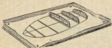
6° INCOLLARE SULLE ORDINATE LA CHIGLIA ED I CORRENTINI FISSANDOLI CON SPILLI
