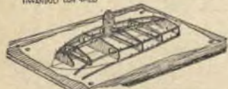
6° FODERARE CON COMPENSATO DI OTTONE FISSANDOLO CON COLLANTE E CHIODINI DI RAME
