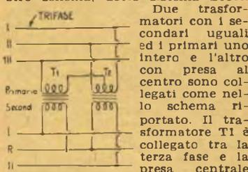
Due trasformatori con i secondari uguali ed i primari uno intero e l'altro con presa al centro sono collegati come nello schema riportato. Il trasformatore T1 è collegato tra la terza fase e la presa centrale del trasformatore T2 mentre quest'ultimo è posto in parallelo tra la prima e la seconda fase. Il trasformatore T1 avendo minor tensione primaria dovrà avere un numero di spire 0,866 volte quelle di T2 (il numero 0,866 si ottiene considerando che la tensione ai
