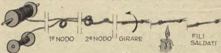
**Q**uando si tratti di bobinare del filo molto sottile — 0,5 mm. e simile — le rotture sono all'ordine del giorno. Fortunatamente non è difficile rimediare con una buona saldatura... autogena per la quale sorgente sufficiente di calore può essere la fiamma della candela od anche di un cerino.
