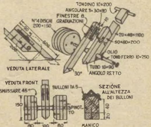
fatte sui fianchi di una delle finestre permettono di regolare l'utensile a seconda della profondità alla quale il solco deve giungere.
