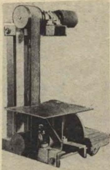
La piccola macchina utensile riprodotta in fig. 1 racchiude in sé una smerigliatrice a nastro, una a disco ed una a tamburo, ed è in grado di sbrigare pressoché ogni lavoro, mentre la sua costruzione è alla portata di tutti.
