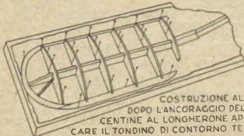
**COSTRUZIONE ALA DOPO L'ANCORAGGIO DELLE CENTINE AL LONGHERONE APPLICARE IL TONDIÑO DI CANTORNO TENENDO IN FORMA GLI SPILLI.**
