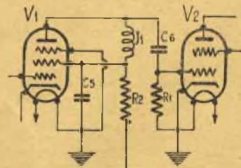
schema corretto che riportiamo. Nel testo a pag. 109 prima colonna riga 16 leggere n. 4 anziché n. 8. Sempre a pag. 109 colonna terza riga 25 e 26 leggere: ... dal piedino 8 della V1 saldare l'impedenza J1 ed il condensatore a mica da 100 microfarad C6...
