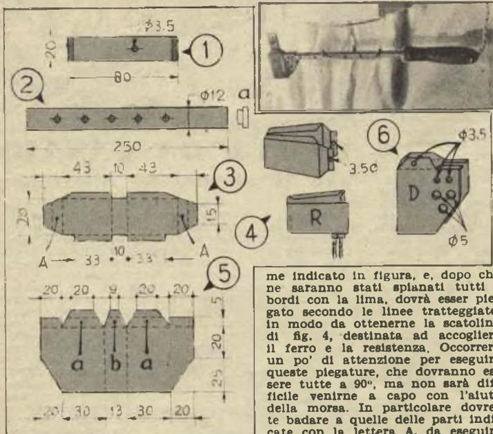
**A** veete bisogno di un saldatore elettrico, e desiderate farvene uno che sia in grado di dare il rendimento dei migliori in commercio? Tutta la spesa necessaria — se volete riprodurre il mio — sarà di 2-300 lire, cioè quanto basta per acquistare una resistenza da 100 watt, adatta alla tensione del settore. Il resto del materiale lo troverete certamente tra i vostri avanzi.
