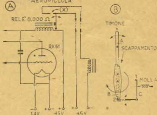
2.) Ecco in sintesi il perché del relais: il segnale radio trasmesso dalla trasmittente e captato dalla valvola RK61 posta sulla ricevente sarebbe troppo debole per azionare, direttamente, il dispositivo di scappamento, che, essendo trattenuto da una molletta offre una discreta resistenza. Si rende quindi necessario l'uso di un relais sensibilissimo e di limitata potenza, atto comunque a chiudere il contatto X e ad immettere corrente nell'elettrolamita dello scappamento.
