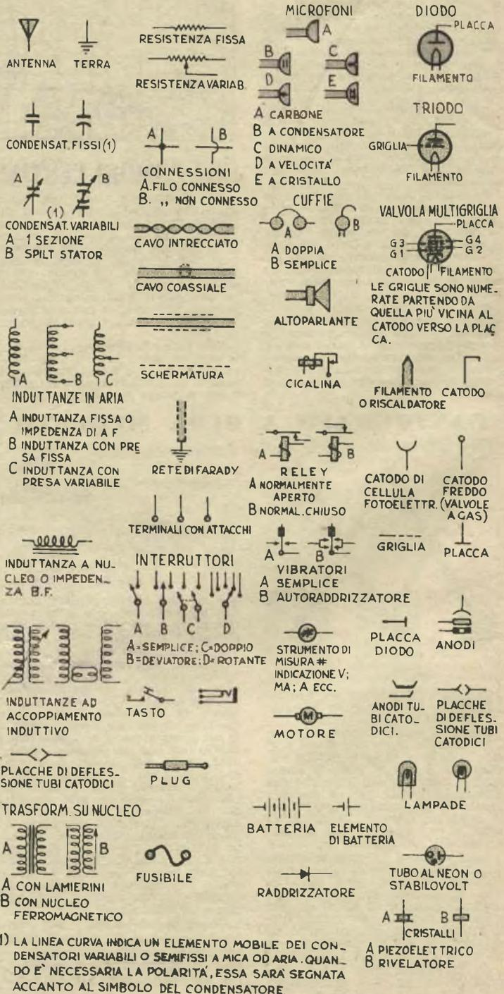
(1) LA LINEA CURVA INDICA UN ELEMENTO MOBILE DEI CONDENSATORI VARIABILI O SEMIFISSI A MICA OD ARIA. QUANDO E' NECESSARIA LA POLARITA', ESSA SARA' SEGNATA ACCANTO AL SIMBOLO DEL CONDENSATORE.
