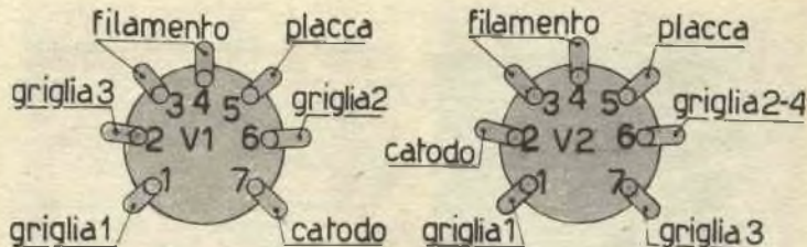
Fig.1 - CONNESSIONI ALLO ZOCCOLO
