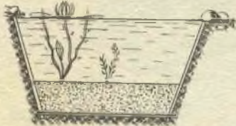
FIG. 1 - SEZIONE SCHEMATICA DELLA VASCA COSTRUITA INTERRANDO UN MASTELLO
